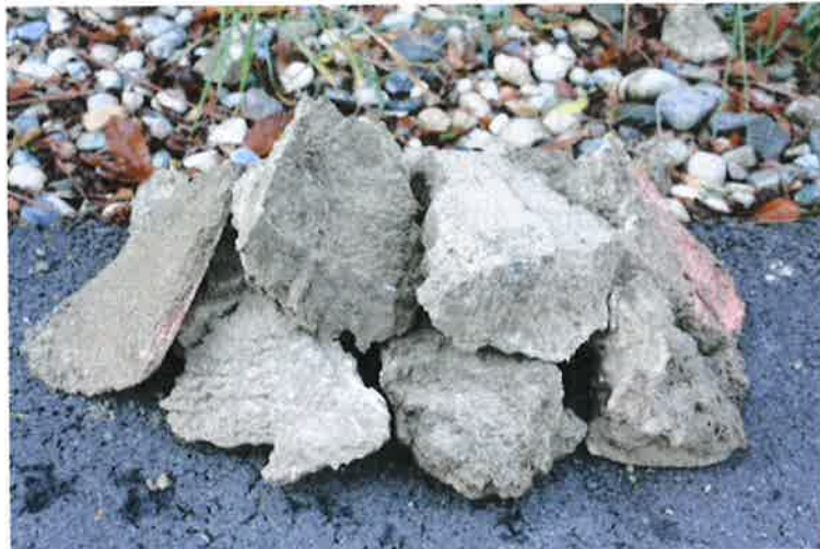
Plaques de calcaire retirées du raccordement à l'aveugle de l'Arzillier
